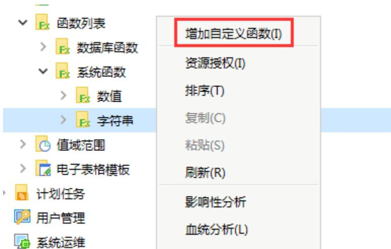
2, 在“字符串”的右键菜单中选择 增加自定义函数，弹出“自定义函数”窗口。
