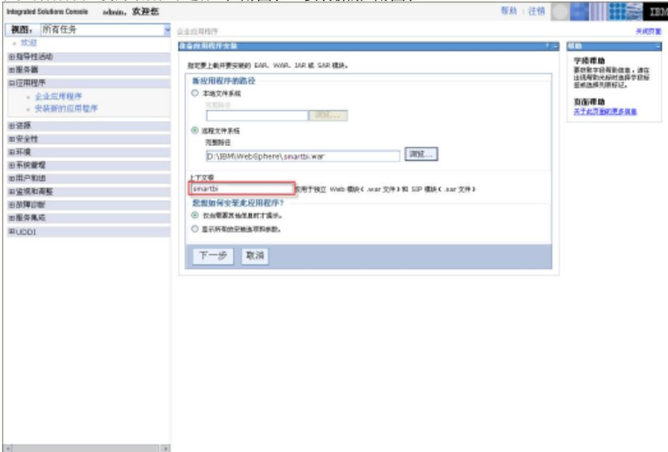
2. 在控制台界面右侧的“新应用程序的路径”中，填入war文件的路径，并输入上下文根为“EssbaseXmla”，然后单击 **下一步**，将显示“步骤1：选择安装选项”界面。
