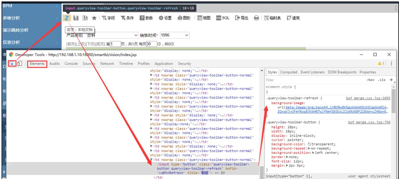
有时候一个样式控制, 譬如颜色, 也许是其父元素的样式继承下来的, 您需要确定是哪个样式起作用, 这时可以在开发者工具右侧styles视图启用、删除或增加样式确认的, 确认好了以后再在样式文件中修改。
